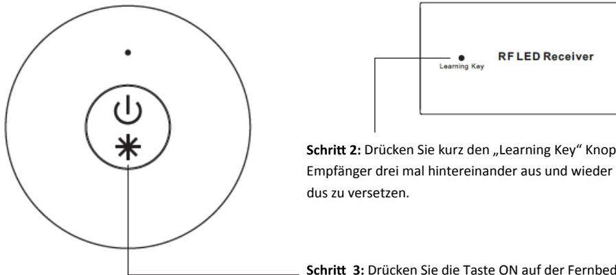
**Schritt 2:** Drücken Sie kurz den „Learning Key“ Knopf auf dem RF Empfänger oder schalten Sie den Empfänger drei mal hintereinander aus und wieder ein, um den Empfänger in den Verbindungsmodus zu versetzen.
